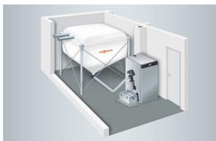
Pelletsilo (Gewebetank) mit Zuführung zum Pelletkessel durch flexible Schnecke
