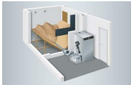
Lagerraum mit Zuführung zum Pelletkessel durch flexible Schnecke
