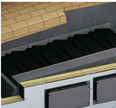
Brennkammer mit Mehrfachisolierung und hochwertiger Schamottierung
