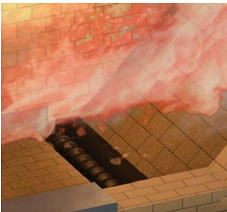
Optimale automatische Entaschung über wassergekühlter Schnecke
