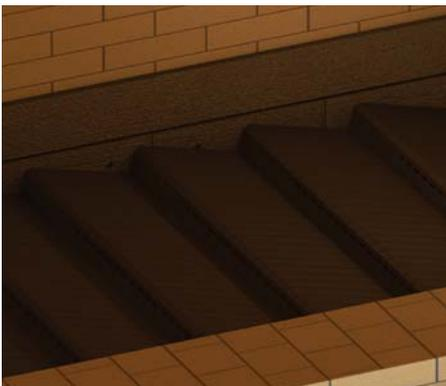
Hydraulisch angetriebener Flachschiebrost
